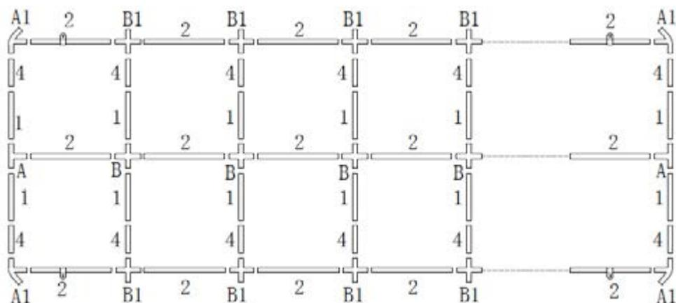
Choisissez un sol plat pour monter votre tente. Assemblez la structure du toit en montant les pièces 1, 2 et 4 sur les jonctions A, A1, B et B1. (comme sur le plan ci-dessus). Les tubes n°1 et n°4 s'assemblent entre eux. Serrez chaque vis de l'ensemble.
