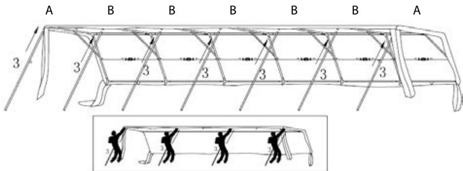
Inclinez l'un des côtés de la structure pour monter les pieds (tubes n°3) dans les jonctions A et B.
