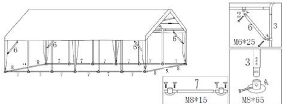
Renforcez la structure aux quatre coins à l'aide des barres de contreventement n°6. Fixez les sur les tubes de 50mm à l'aide des colliers 50 et des vis papillon M6\*25.
