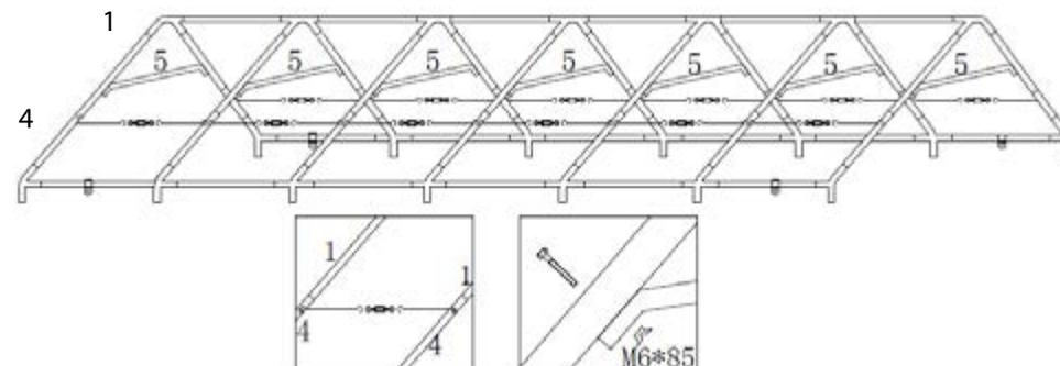
Mettez en place les barres de renfort du toit n°5 en les reliant au tube n°4 (visser à l'aide des vis M6\*85. Une fois installée, elles doivent être parallèles les unes aux autres.
